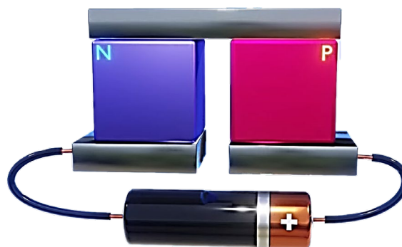
Figura 7 Cella di Peltier - schema
