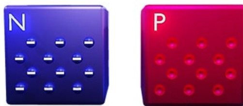
Figura 6 Tipologie di drogaggio
